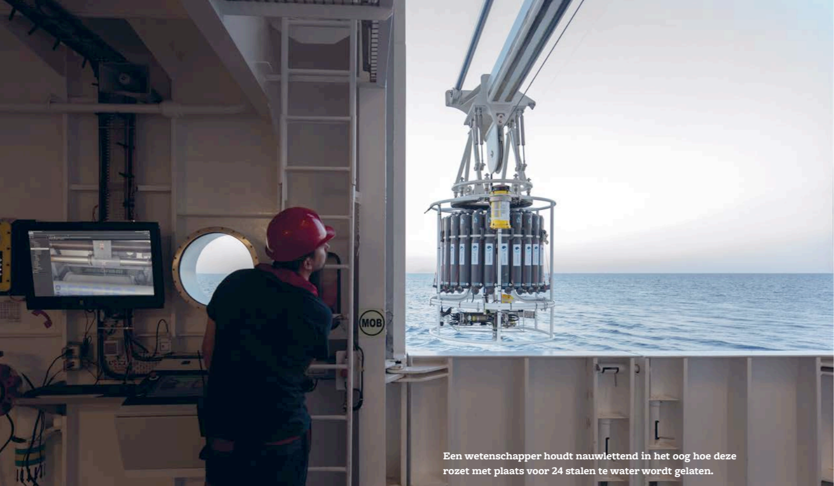
Ook 's nachts wordt er verder gewerkt. De rozet bevat ook een CTD, een instrument dat o.a. de geleidbaarheid, temperatuur en diepte meet.
