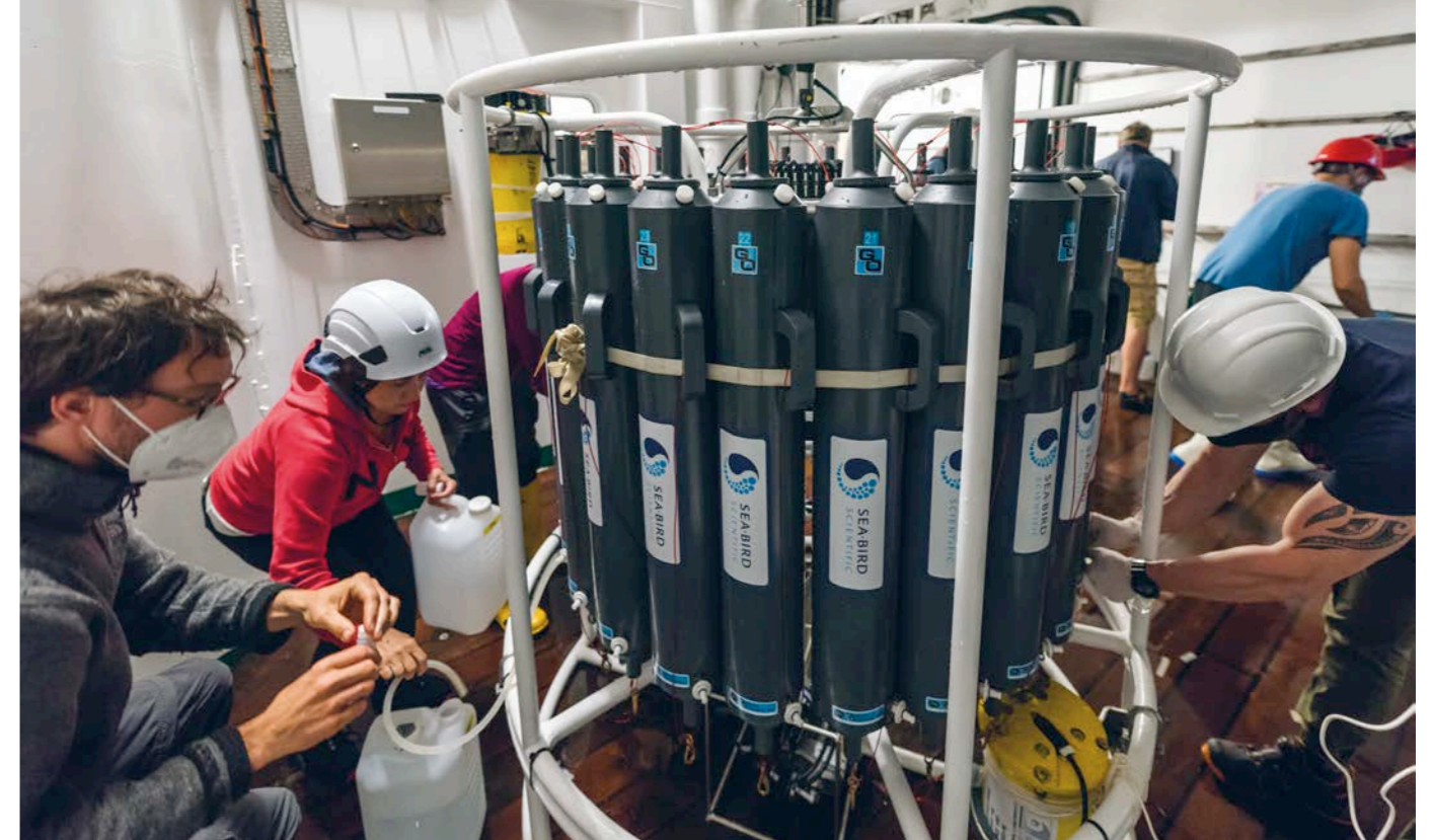
Verschillende Europese wetenschapsteams onderzoeken water uit dezelfde stalen, genomen op verschillende dieptes in de (verticale) waterkolom, om o.a. het zuurgehalte, zuurstofgehalte, CFK's en zelfs radioactiviteit te meten.
